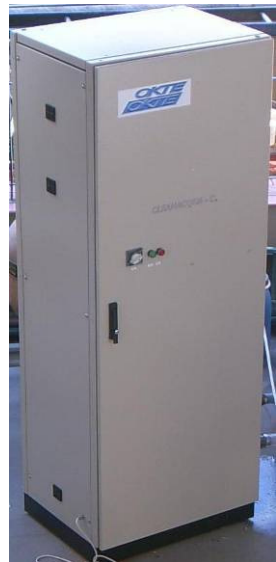
Sistema de Reciclagem de Água Processo com O 3 +Flotação+Filtro Areia+Nanofiltração
